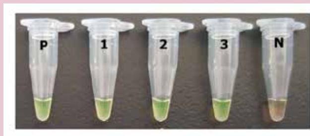
รูป การตรวจยืนยันเชื้อวัณโรคด้วยวิธี LAMP: P; หลอดควบคุมบวกมีดีเอ็นเอเชื้อวัณโรค, N; หลอดควบคุมลบไม่มีดีเอ็นเอของเชื้อวัณโรค, 1-3 หลอดทดสอบเตรียมจากตัวอย่างเชื้อที่เพาะขึ้น ผลตรวจบวกมีสีเขียว พบเชื้อวัณโรค
