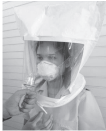
รูปที่ 9.15 การทดสอบความแนบสนิทการใส่หน้ากากชนิดใช้แล้วทิ้ง ด้วย fit test kit ที่มา: คู่มือปฏิบัติการป้องกันและควบคุมการติดเชื้อในโรงพยาบาล
