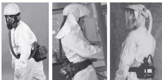
รูปที่ 9.10 เครื่องกรองอากาศที่จัดส่งอากาศให้ แบบหน้ากากครอบเต็มใบหน้า (ซ้าย)
