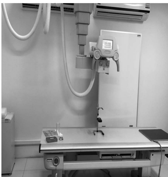
รูปที่ 11 การจัดอุปกรณ์วัดรังสีด้านการตรวจสอบคุณภาพเครื่องเอกซเรย์
