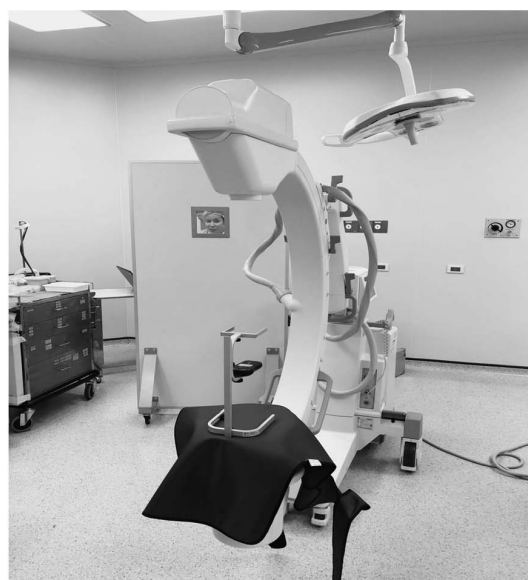
รูปที่ 11 การจัดอุปกรณ์วัดรังสีด้านการตรวจสอบคุณภาพเครื่องเอกซเรย์
