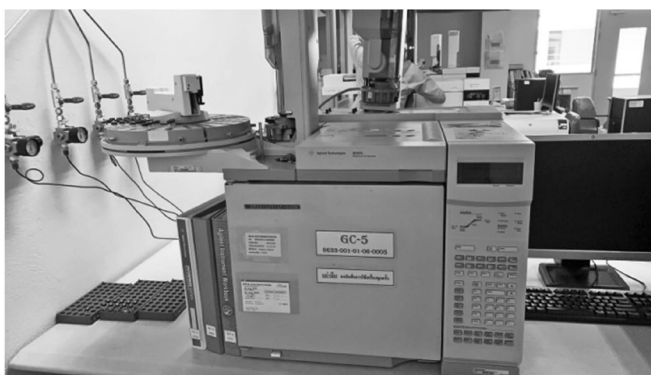
รูปที่ 8 เครื่อง Gas Chromatography ที่มีสารกัมมันตรังสี Ni-63
