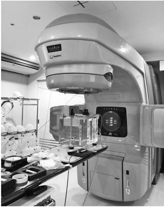
รูปที่ 10 การจัดอุปกรณ์วัดรังสีด้านการตรวจสอบคุณภาพเครื่องรังสีรักษา
