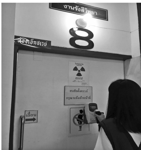
รูปที่ 10 การวัดปริมาณรังสีกระเจิงรอบห้องเอกซเรย์
