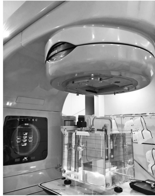
รูปที่ 10 การจัดอุปกรณ์วัดรังสีด้านการตรวจสอบคุณภาพเครื่องรังสีรักษา
