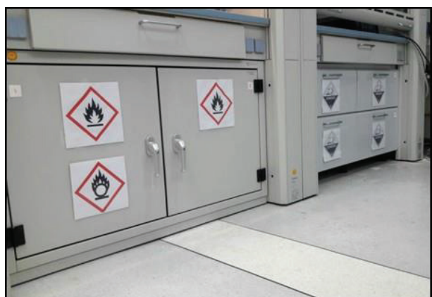
รูปที่ 8 ตู้สำหรับเก็บสารเคมีแยกตามประเภทความเป็นอันตราย
