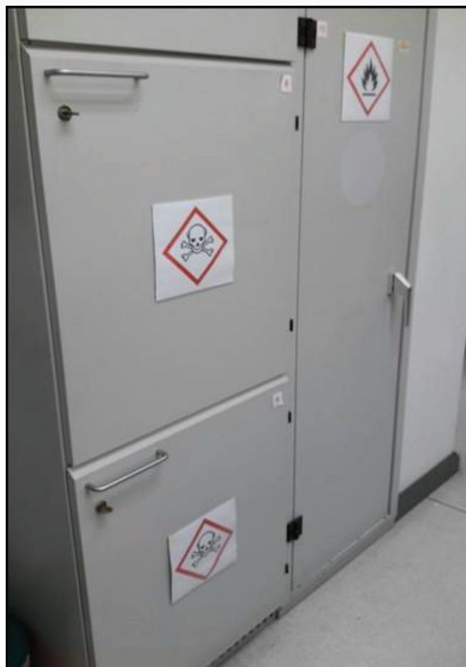
รูปที่ 8 ตู้สำหรับเก็บสารเคมีแยกตามประเภทความเป็นอันตราย
